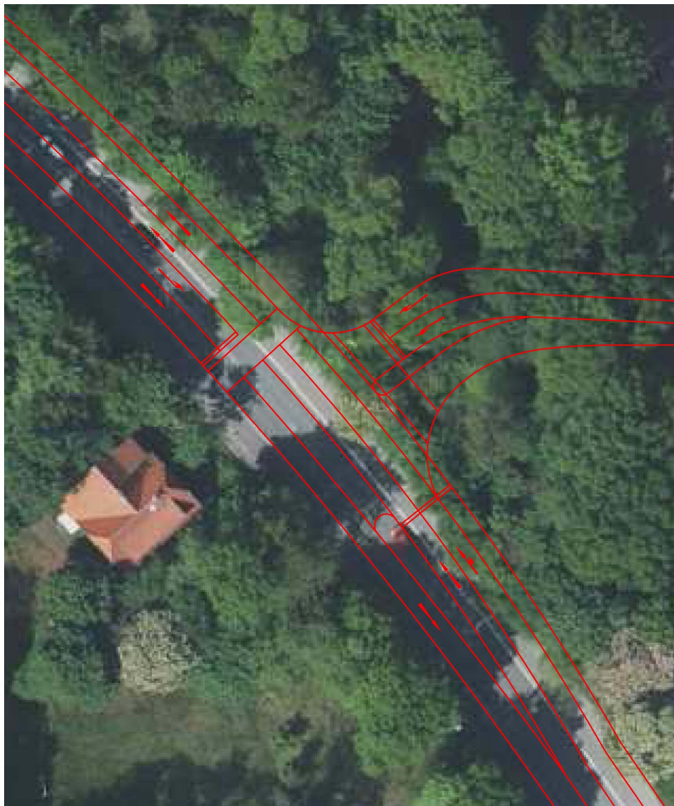
Bild 13: Planungsskizze für den neuen Knotenpunkt zur Anbindung des Mansergh Quartiers an die Verler Straße
