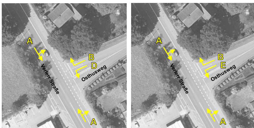
Bild 23: Verkehrsqualitäten (QSV) am Knotenpunkt Verler Straße/Osthusweg in der vormittäglichen (links) und nachmittäglichen (rechts) Spitzenstunde im Prognose-Nullfall
