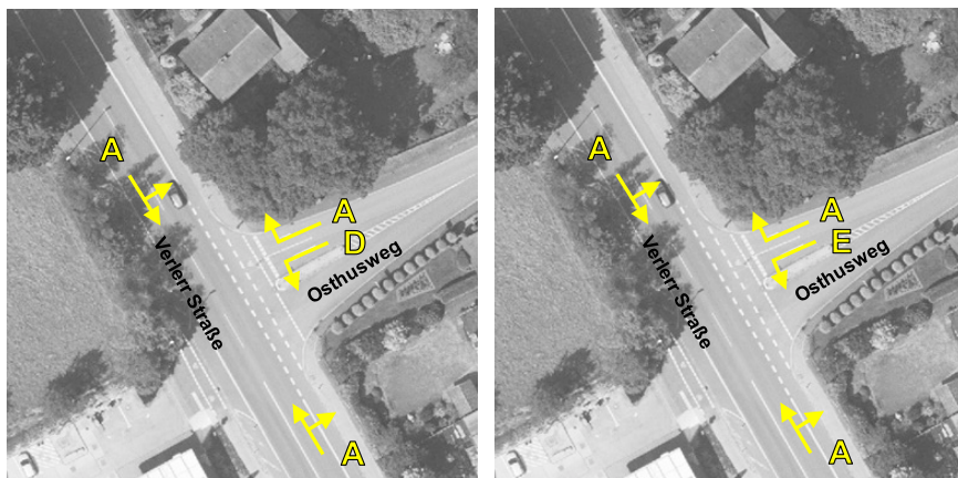
Bild 22: Verkehrsqualitäten (QSV) am Knotenpunkt Verler Straße/Osthusweg in der vormittäglichen (links) und nachmittäglichen (rechts) Spitzenstunde in der Bestandssituation (Analysefall)
