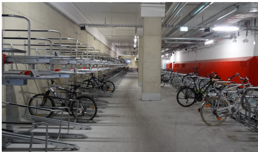
Bild 29: Gestaltungsbeispiel für eine Fahrradgarage mit Einfachparken und Doppelstockparken
