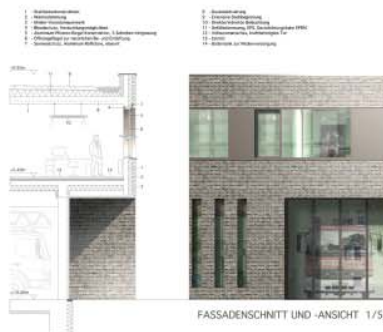
FASSADENSCHNITT UND -ANSICHT 1/50
